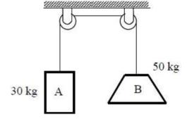
14. Suponiendo que la masa de la polea doble es despreciable y que el conjunto está originalmente en reposo, calcule la velocidad que tendrá el cuerpo *B* cuando *A* haya ascendido 3 ft.
