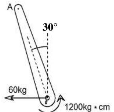
19. Se desea sustituir la fuerza y el par que actúan sobre el cuerpo de la figura por una sola fuerza. Diga qué magnitud, dirección y posición debe tener ésta sin que se alteren los efectos externos.
