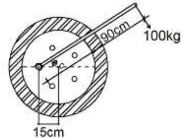
5. Determine el valor que debe tener el ángulo  $\theta$  del problema anterior para que el momento de la fuerza con respecto al centro de la llanta sea máximo. Recuerde que la dirección de la fuerza de 100 kg debe ser normal al eje de la llave.
