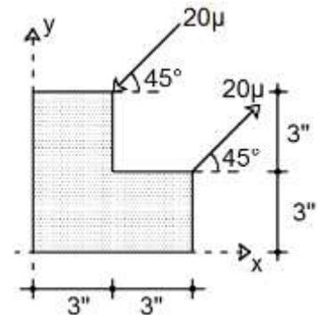
11. Determine el sistema resultante de las fuerzas que actúa sobre la armadura de la figura.
